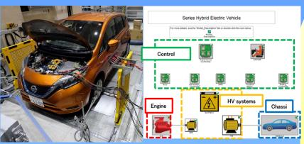
シャシダイナモを用いた車両試験および1-Dモデルの概要
